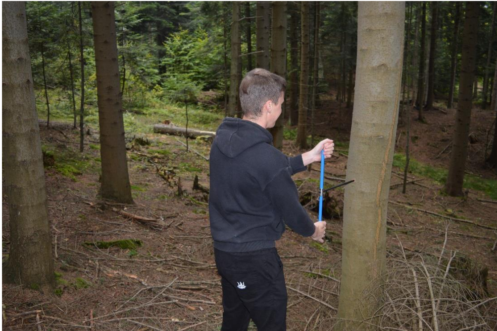
Fot. 11. Uczeń ze szkoły średniej podczas odwiertu rdzenia z drzewa przy wykorzystaniu świdra Presslera podczas warsztatów terenowych
